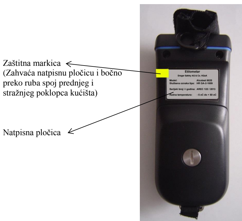
Slika 9. Postavljanje ovjerne markice – pogled s boka uređaja
