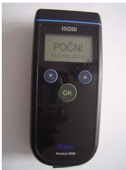
Slika 6. Prikaz LCD zaslona: Samotestiranje
