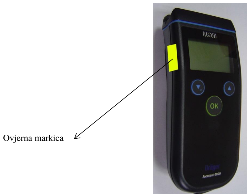
Slika 9. Postavljanje ovjerne markice – pogled s boka uređaja
