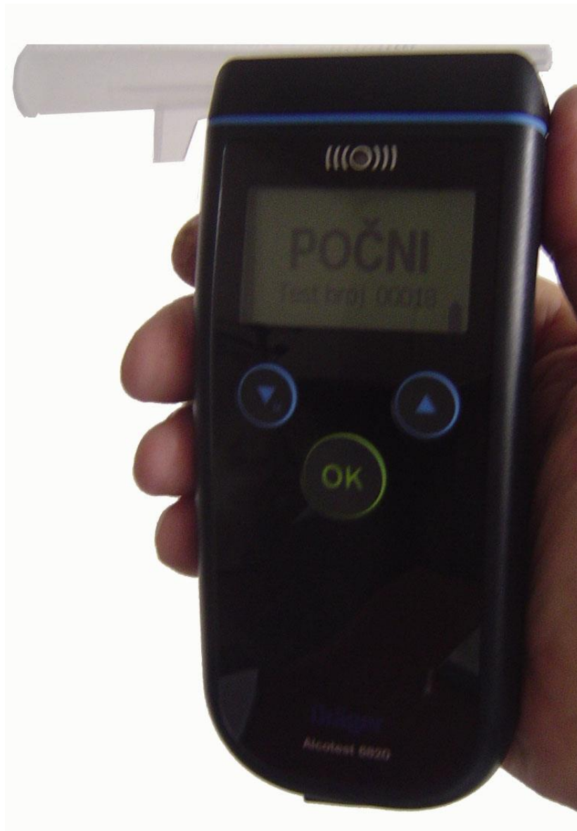
Slika 11. Uređaj Alcotest 6820 pripremljen za mjerenje
