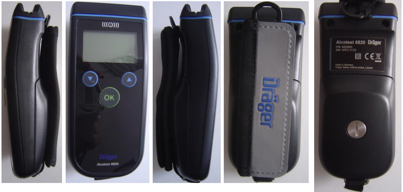
Pogled straga tvornička pločica i poklopac baterije, vijci za otvaranje kućišta
